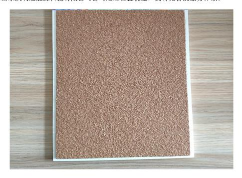
天然真石漆施工常见问题。有些天然真石漆涂层在每次下雨以后,都会发白,涂层变得疏松,而在雨停后,经太阳一晒,涂层又恢复原来的颜色. 这是由于涂层的耐水性不好、吸收了水分造成的,配方选用的丙烯酸乳液在合成时需加入表面活性剂,有些厂家为了增加乳液的稳定性,所用的表面活性剂极大超量;有些厂家在制备天然真石漆时加入羧甲基纤维素、羟乙基纤维素等物质作为增稠剂,以及加入苯甲酸钠作为防腐剂. 这些物质都是水溶性的或亲水的,涂料成膜后留在涂层中,就极大降低了涂层的耐水性能.由于天然真石漆的涂层较厚,一旦吸收了水份后,不容易在较短的时间内释放出来,因此造成外观发白,涂层内部疏松的结果. 天然真石漆在干燥后具有良好的耐水性,因此涂层在干燥后遇水不会出现发白的现象。
