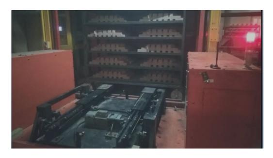
RGV小车是物料搬运的重要设备,其运行效率直接决定了整个系统的处理能力。以往传统的RGV系统多为直线轨道的单车或双车系统,一般满足小区域中低运行频率。对于像亚洲一号仓库这样运输线10万平方米、10公里以上的仓储系统,需要一个环形轨道的多车系统来满足运输需求。无换轨能力的普通环轨多车系统由于作业路径固定、作业效率低,不适合布置在大型物料搬运区域,而具有大流量搬运能力的过渡RGV系统可以发挥路径可变、作业灵活的优势,满足多个库区之间的大规模、大流量物料搬运作业,是解决大型电商物流系统中物料运输问题的重要技术手段□RGV小车作为仓库的外部设备,可以方便地自动连接其他物流系统,如出入库平台、各种缓冲站、输送机、电梯、机器人等。以便按计划运输材料。此外,它不需要人工操作,运行速度快,较大降低了存储成本,提高了劳动生产率。同时,班车的应用可以使物流系统变得非常简单。
