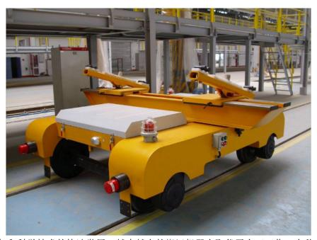
随着人工智能的兴起和科学技术的快速发展,越来越多的搬运机器人取代了人工工作。在移动机器人市场,除了AGV□RGV自动化物流系统中扮演着各自的角色。那么RGV和AGV有什么区别□AGV小车可以沿着指定的引导路径行驶,以轮式运动为特点。与步行、爬行或其他非轮式移动机器人相比,它具有动作快、效率高、结构简单、可控性强、安全性好等优点。与物料运输中的其他设备相比□AGV的可移动区域不需要轨道支撑架等固定设备。并且不受场地、道路和空间的限制。因此,在自动化物流系统中,可以充分体现自动化和灵活性,实现高效、经济、灵活的无人化生产□RGV:RGV小车指的是轨道导向车辆,也称为轨道穿梭车,可用于高密度储存的仓库。小车通道可以设置为任意长度,可以提高整个仓库的存储能力。而且在作业过程中,不需要驾驶叉车进入巷道,安全性会较高,有效提高仓库的作业效率。河北RGV轨道搬运车RGV轨道式自动导引车设计为双工位车型,直线往复式,移载方式为链条移载,总载重量3t□
