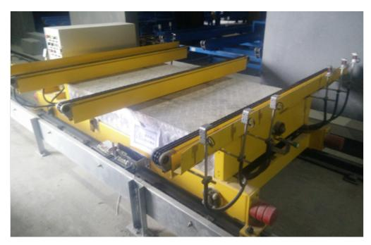
RGV小车根据功能的不同□RGV可以分为两种类型:装配RGV系统和运输RGV系统,主要用于物料运输和车间装配。按运动方式可分为环形轨道式和直线往复式。环形轨道式RGV系统效率高,可同时工作,一般采用铝合金轨道;通常,直线往复式RGV系统包括一个RGV往复,其效率低于环形RGV系统□AGV系统广泛应用于智能仓储和柔性生产线,也是众多制造业提高生产效率、降低企业成本的较新选择。因为在制造仓库和工厂处理货物总是消耗大量的人力,效率低下且容易出错;使用AGV台车可以轻松完美地解决这个问题,不仅降低了人工成本,也让工作环境更加安全□RGV小车的数量较多,对轨道系统的供电要求较高。河北RGV轨道搬运车
