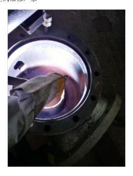
当煤化工系统运行不稳定时,设备内的介质受系统压力、温度变化的影响,介质中的颗粒及杂质会冲进阀体内,部分固体杂质落到密封面上使阀芯与阀座间产生间隙造成渗漏,并在密封面形成压痕,存积在密封面间的介质腐蚀产生的凹坑沟痕,造成介质的持续泄漏或粘连而无法满足生产要求,这时要对安全阀进行维修。安全阀的修理主要是对安全阀密封面的修理,化工设备上的大多数安全阀经使用后残留刺鼻的化学物品,拆卸时应注意防护。部分安全阀的阀体、弹簧上粘连着凝固介质,解体后应采用高温蒸汽或其它不易腐蚀的清洗剂去除残留物。淮安化工安全阀维修厂家上海沙威阀门有限公司设备的引进为用户提供了更多的选择空间。
