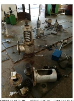
阀门启用不灵敏及处理方法: 1)调整圈调整适当,使阀门开启过程时间延长或回座延迟,并重新调整。2)因内部零件有卡阻现象,可能装配不当,脏物混入或零件腐蚀等造成,应查明原因并消除。3)排放管道阻力过大,
