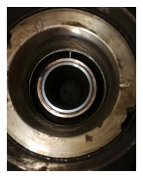
安全阀的工作环境不良,赃物及杂质混入阀体内造成阀体各个零部件卡阻、锈死、腐蚀,活塞室表面光洁度差,表面损伤,有沟痕硬点等缺陷造成的,解决这种方法主要是安全阀的工作环境要尽量的保持清洁、干燥,要经常对安全阀进行保养,维修。安全阀在装配过程中要注意:①各部分零件要清洗干净;②要保护好阀座密封面,然后把调解圈旋到阀座上,其位置一定要比密封面低1□2mm□③阀座、阀瓣密封面要清理干净,一定要把导向套定位到下阀体的止口上;④阀杆、弹簧座、弹簧要装配得当,不能上偏;⑤阀体的紧固螺丝要对称上紧:⑥安全阀要进行密封性试验,直到校验合格。
