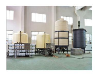
塑料储罐安装时需要注意哪些事项: 1. 塑料的其他配件(如液位管阀,法兰填圈,测温管,管道阀门,管道等)材料必须耐盛装物质溶液,并定期检查这些接口阀门的密闭性,防止漏液。2. 滚塑塑料储罐为常温常压容器。图纸标明则为其工作温度和压力。根据塑料的特性比较高工作温度可为70℃以下,比较高工作压力有设计塑料厚度决定。3. 塑料出口或进口安装泵等机械设备时,应避免强力振动,损坏法兰口,应装管道减振管。4. 滚塑塑料储罐,在盛装某些比重较大的液体时候,要配置抱箍加补强套,防止塑料储罐承压称重过大变软变形,也有利于储液安全。绍兴大型塑料储罐多少钱塑料储罐安装说明:场地四周应有良好的排液地沟与稀释装置。
